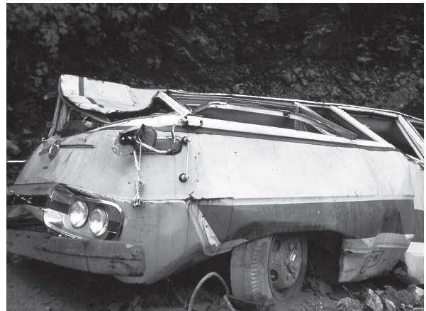
図8、雪の沈降圧で引き潰れたマイクロバス
